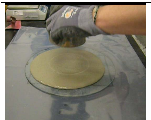
Figura 3 – Prova di spandimento con il cono per le malte
