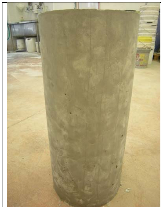
Figura 4 – Cilindro di prova dopo rimozione del cassero (altezza 50 cm)
